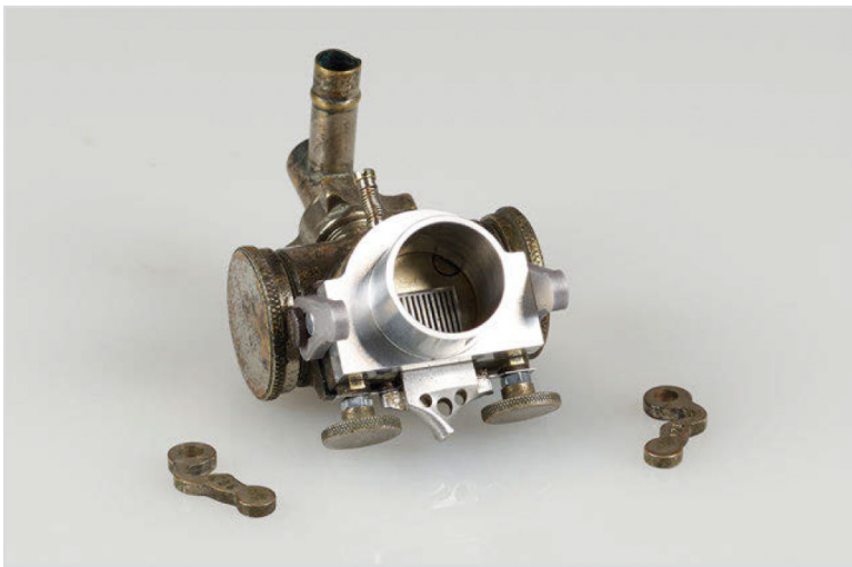
Abb. 4: Der restaurierte originale Stentorphone-Klangkörper mit neuer Frontpartie, neuen Umlenkhebeln und Torsionsschraube.
