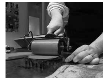
Afbeelding 6. Still van een gopro-video die de werkplaatsspecialist toont tijdens het ininken van een drukvorm in de boekdruk- en boekbindwerkplaats, december 2023
