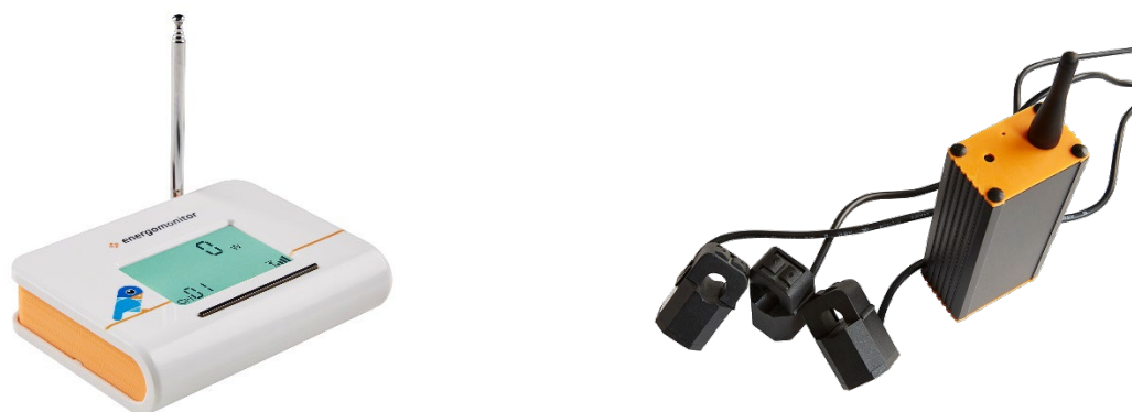
Abbildung 15: Komponenten des Messsystems zur Scheinleistungsmessung (links Homebase, rechts Dreiphasen-Sensor) [131]
