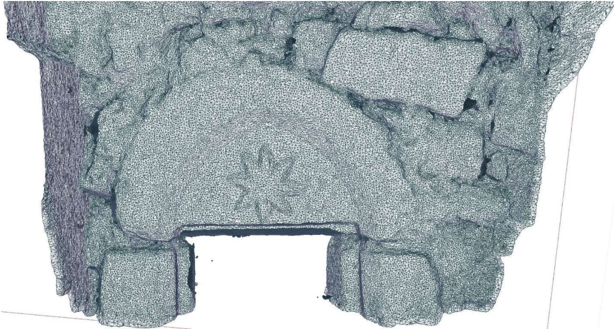
Abbildung 7 - Fotogrammetrische Aufnahme des gleichen Architekturdetails als 3D-Oberfläche
