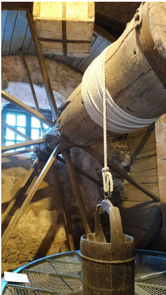
Abbildung 2 - Rekonstruiertes Laufrad am Brunnen der Ronneburg
