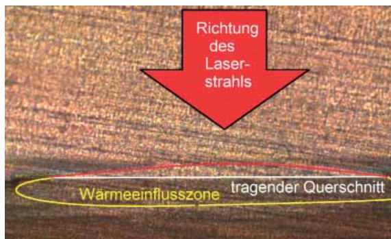
Bild 5: Im Schliffbild einer Laserschweißnaht von transparentem Kunststoff (oben) und optisch absorbierendem Kunststoff (unten) ist der tragende Querschnitt (weiße Linie) zu erkennen
