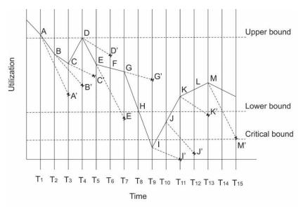
Fig. 7. Dynamic load balancing scenario.
