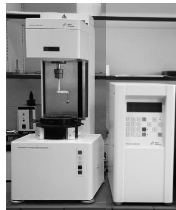
Abb. 1: Kugelmesssystem nach Tyrach & Müller /1/
