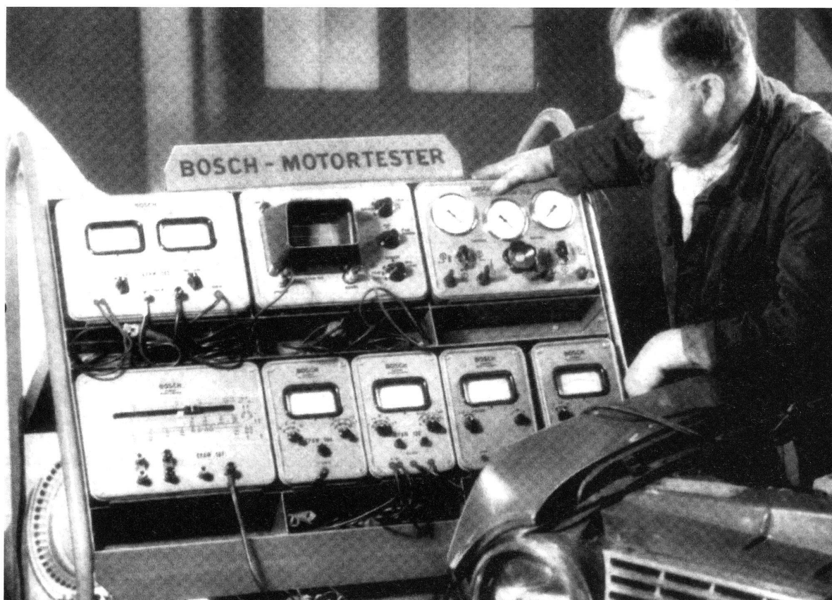
Das Bosch Baukastensystem ermöglichte die flexible Integration einzelner Testgeräte zum Grosstester.
