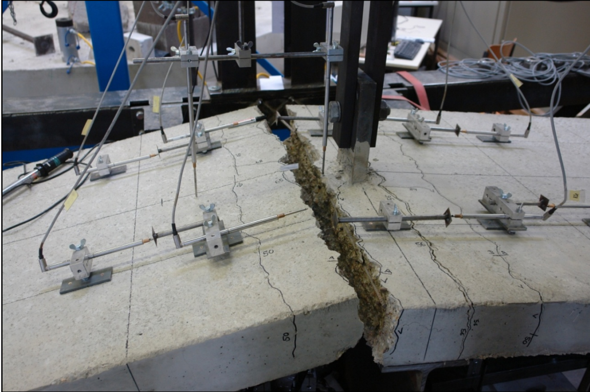
Bild 4.27 Betonplatte des Versuchs C-2 nach versagen der Betonplatte
