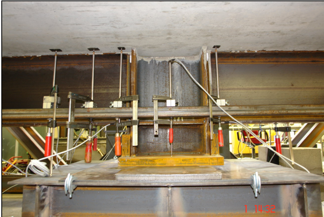
Bild 3.8 Wegaufnehmer im Bereich der Stütze, linke Seite
