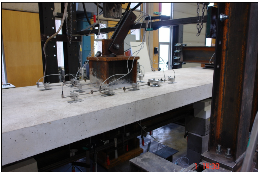
Bild 3.9 Wegaufnehmer auf der Betonplatte
