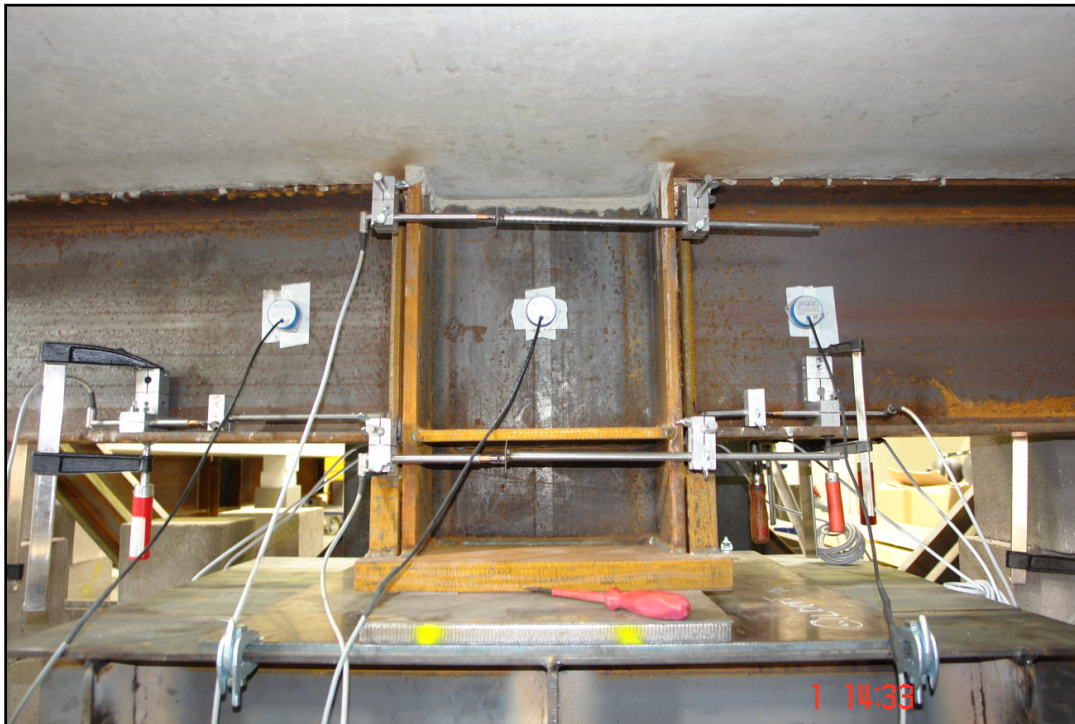
Bild 3.7 Wegaufnehmer im Bereich der Stütze, rechte Seite
