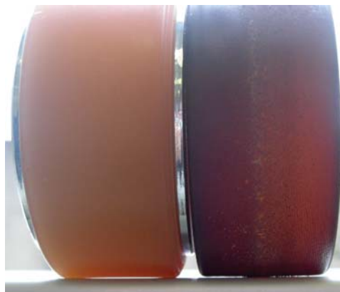
Abbildung 6.14: Neue Rolle (konkav), abgenutzte Rolle (konvex)
