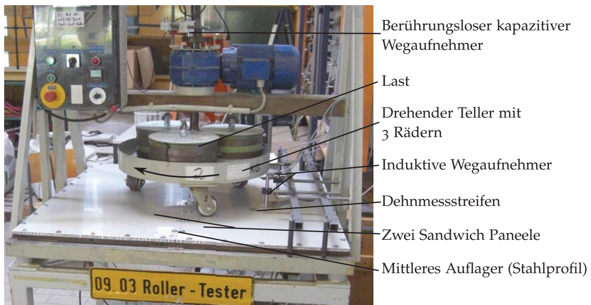
Abbildung 10.1: Food-Cart Roller Versuchsaufbau, nach Spezifikation [12, 15]
