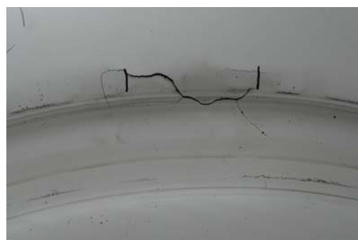
(b) Riss im Deckblech bei 62^\circ
