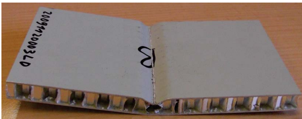
Abbildung 7.1: Kerneinbuchtung nach einem Beulversagen (L-Probe)
