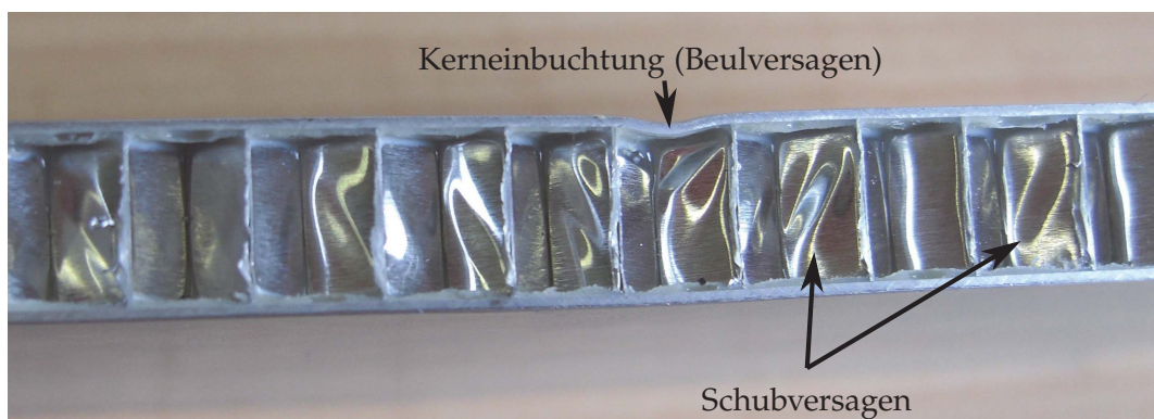
Abbildung 7.5: Kerneinbuchtung einer W-Probe mit überlagertem Schubversagen (quasi-statisch)
