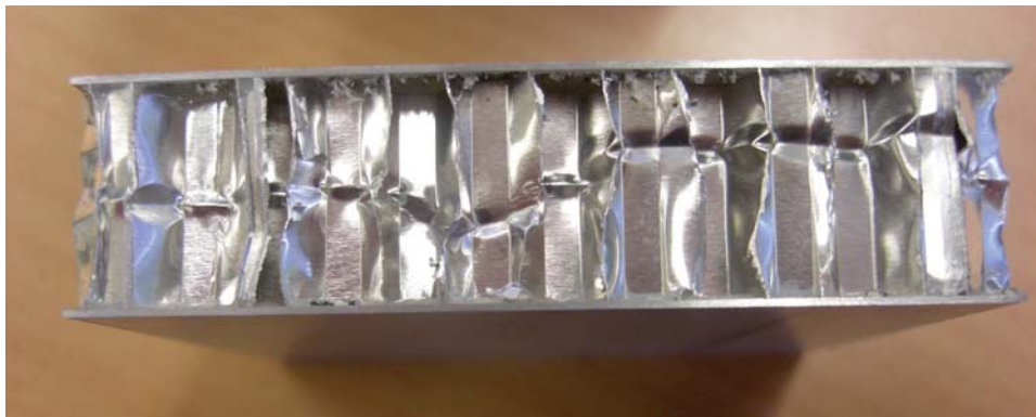
Abbildung 4.3: Druckprobe nach dem Beulversagen
