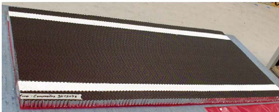
Abbildung 11.2: Wabenkern am Rand mit weißer Pottingmasse gefüllt
