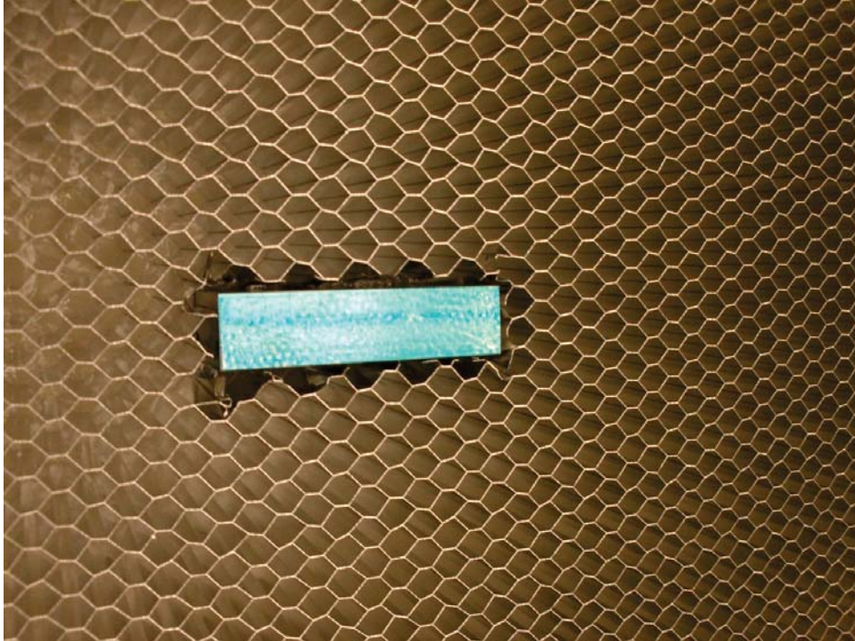
Abbildung 11.8: Wabenkern mit eingefügtem Aluminiumeinleger
