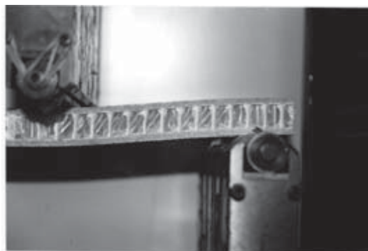
Abbildung 2.11: Statisches Schubversagen im Kern einer Sandwichstruktur belastet in einem 4-Punkt Biegeversuch nach Meraghni [72]
